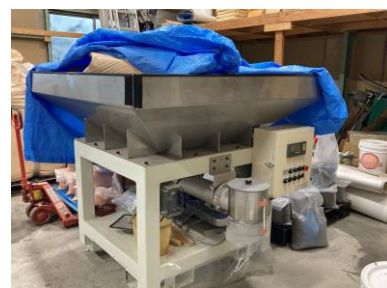
導入した自動計量できる材料袋詰め装置
