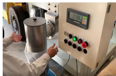
粉末化した廃瓦12kgを自動的に袋詰めしている様子
