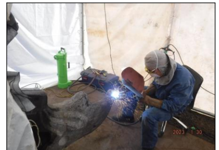
テスト材による溶接作業 (大割圧碎機)
