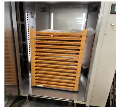
常温除湿乾燥機による乾燥加工
