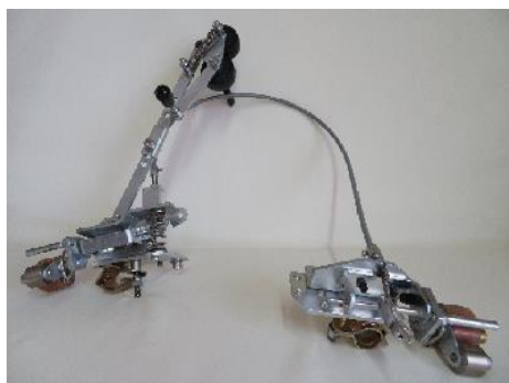
特許を取得した制動装置(ブレーキ)
